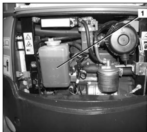
War der Kühlflüssigkeitsausgleichsbehälter vollständig entleert, ist der Flüssigkeitsstand im Kühler zu prüfen.
