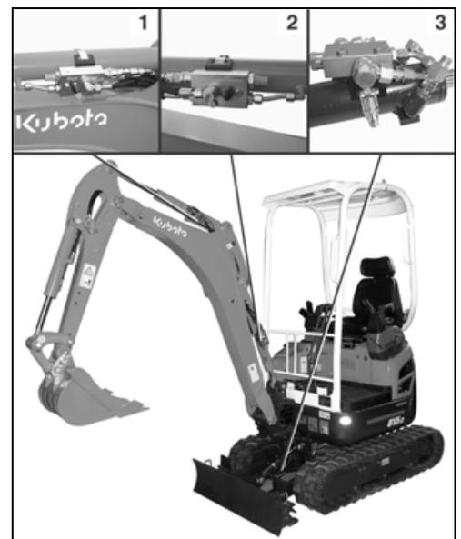
Die Rohrbruchsicherung (1) ist werkseitig auf den jeweiligen Bagger eingestellt und mit einer Plombe (2) gesichert.
