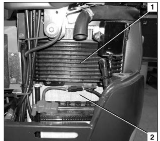
Nach dem Reinigen Kühler auf Beschädigungen prüfen.
